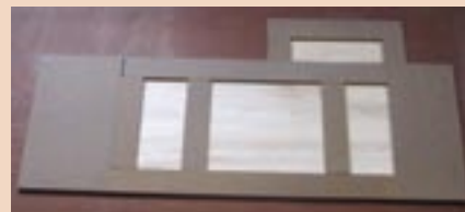
Moldura posterior, que permite colgar el mueble en la pared.
