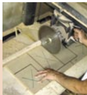
Corte de la parte figurada usando la sierra radial.
