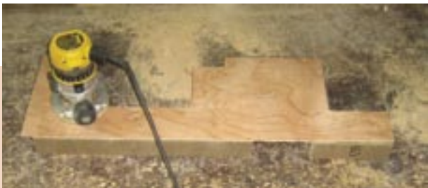
Enchapado de la parte figurada usando Meple de 2.0 mm.
